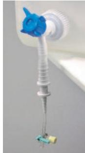
三方活栓を取り付ける。3Lを越える廃液の処理に便利です。
