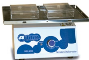
WSC-2400 シーソーシェーカー atto 振とう台全体が同じ角度に傾き、振とうムラが起きにくい構造の振とうです コード No.2312200 定価 148,000 円
