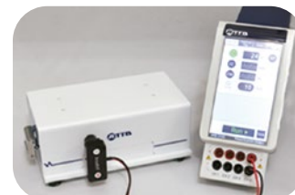
④ リード線をセットして、電源装置に接続しブロッティングを開始します
