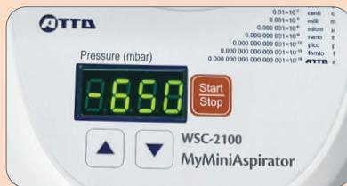
操作パネルは圧着式で、手袋を着用したままでもスムーズに操作できます。吸引圧力は矢印キーで簡単に調整でき、Start/Stop ボタンを押すだけで吸引の開始・停止が可能です。設定可能な吸引圧力は -30 ~ -650 mbar と広範囲に対応しており、用途に合わせた精密な調整が行えます。
