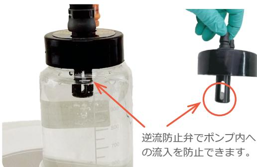
目を離している間に廃液がボトル満量に達しても、慌てる必要はありません。ボトルの最大容量を超えると、キャップの排気側に設置されたフロート式ボール弁が作動し、ポンプへの液体の流出を自動的に防止します。安全性と信頼性を確保した安心設計です。
