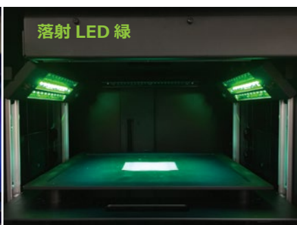
光源とフィルターの組み合わせ Epi-G = BPF595
