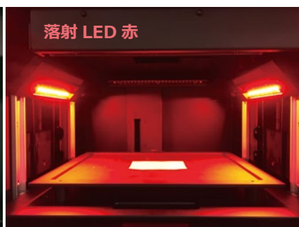
光源とフィルターの組み合わせ Epi-R = BPF680
