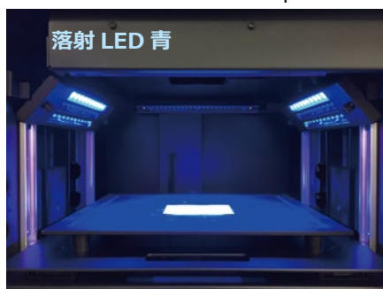
光源とフィルターの組み合わせ Epi-B = BPF535
