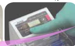
電源をON モードを選択し Runボタンで泳動開始
