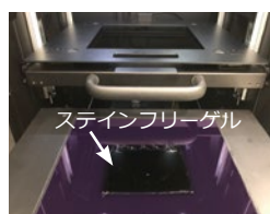
撮影装置 LuminoGraph III の UV 照射面
