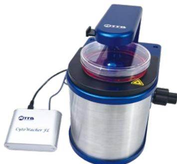
「CytoWatcher II」は、生きたままの細胞や組織を、ダメージを与えることなく、長期間にわたって撮影できるデジタル顕微鏡です。省スペース、省電力設計なので、CO<sub>2</sub> インキュベータ内にコンパクトに収まり、環境温度への影響を最小限に抑えます。明視野撮影はもちろんのこと、蛍光撮影にも対応しており、再現性抜群のカラー撮影は組織切片や生体組織などの観察にも適しています。本システムは、CytoWatcher II 本体、制御用 PC、蛍光撮影ユニットを組み合わせた ALL IN ONE モデルです。
