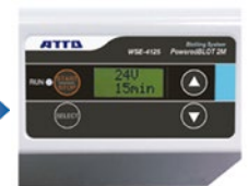
⑤ モードを選択し、RUNボタンを押してブロッキングを開始します
