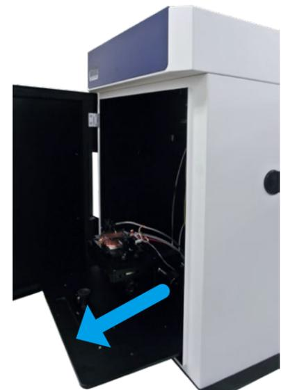
太陽電池の固定、電極のセットを容易にするために、試料台を手前に引き出すことができます。
