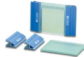
ガラスプレートの上にシールガasketを置きクリップで固定します。
