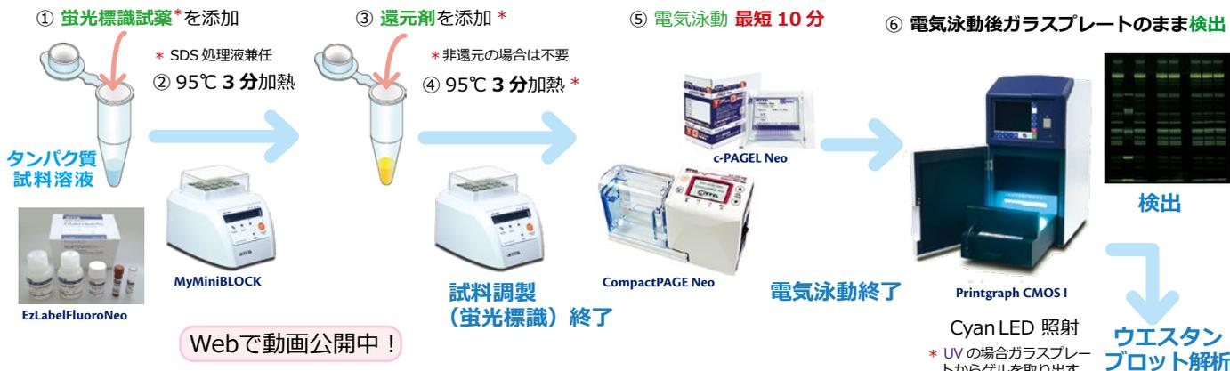
通常の SDS-PAGE 用サンプル処理とほぼ同じ操作、試料処理溶液を「EzLabelFluoroNeo」に換えるだけで蛍光標識が可能です。泳動後は染脱色なしにガラスプレートごと蛍光検出できます。「コンパクト PAGE Neo」 「c-PAGEL Neo」を利用すれば 20 分以内で検出まで実施。しかも高感度でさらにプロットも OK です。
