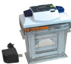
電源搭載型泳動装置
