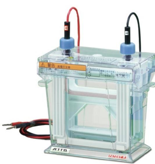
※ およそ電流200mA、電圧500Vまでの出力が可能な電源装置と接続してご使用ください。
