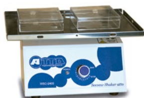
WSC-2400 シーソーシェーカー atto 振とう台全体が同じ角度に傾き、振とうムラ が起きにくい構造の振とうです コード No.2312200 定価 155,000 円
