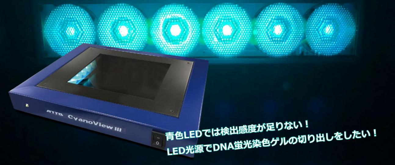
**CyanoView** (シアノビュー) は、青緑LED(470～510nmメイン)の蛍光励起用LED透過光源です。エチジウムブロマイド (EtBr) をはじめ、GelRed、SYBR Dye、SYPRO Dye、Pro-Q Diamondなどの蛍光物質を励起可能です。ゲル電気泳動後のタンパク質や核酸などの蛍光検出が安全に行えます。ATTO LuminoGraphシリーズ/Printgraphシリーズなど、各種イメージング装置で使用可能です。撮影にはYA-3またはR-60などの撮影用フィルターが必要です。
