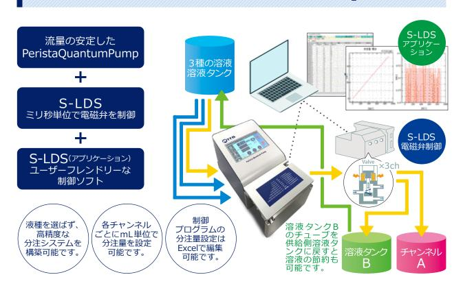
価格:120万円 $\sim$  (PeristaQuantumPump1台、制御装置-式)
