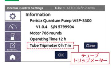
附属のチューブトリップメーターにより、 チューブの使用経過時間が確認でき、交換 時期が予測可能です。
