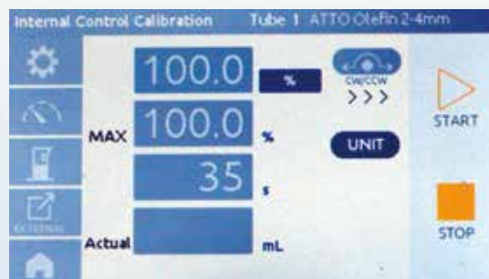
②スタートボタンで 2min 間の送液が始まる この送液量を実測
